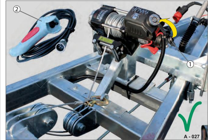
Fig. 18 Treuil électrique en position de conduite
