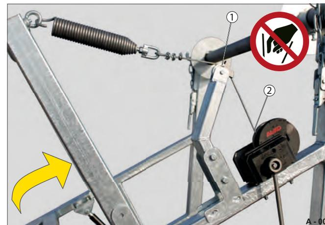
**Fig. 21** Zones d'écrasement / de cisaillement
