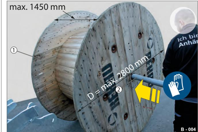
Fig. 6 Mise en place de l'axe de transport
