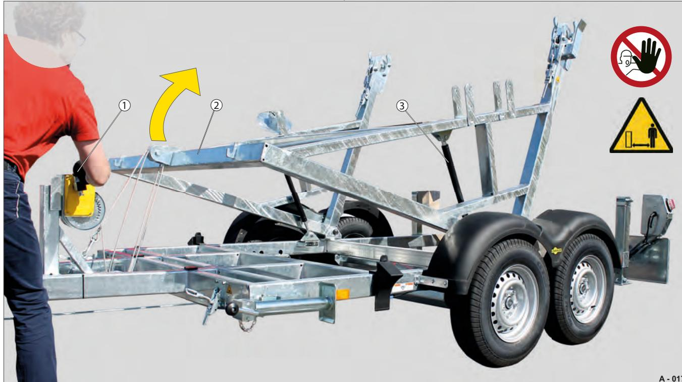
Fig. 8 Basculement du châssis porte-touret vers l'arrière
