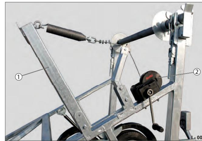
**Fig. 8** Cadre de freinage (en option)
