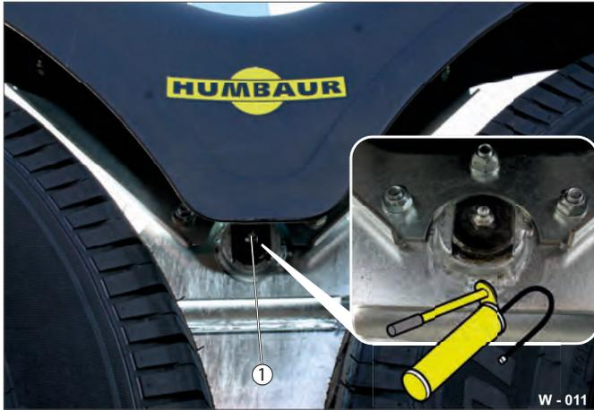
**Fig. 11** Paliers / points de lubrification du châssis porte-touret
