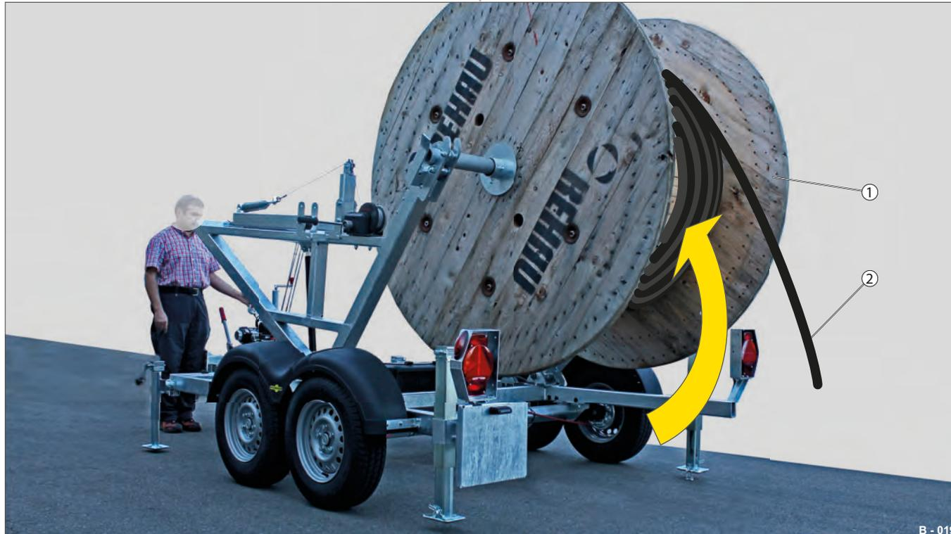
Fig. 16 Montée du touret / utilisation du câble
