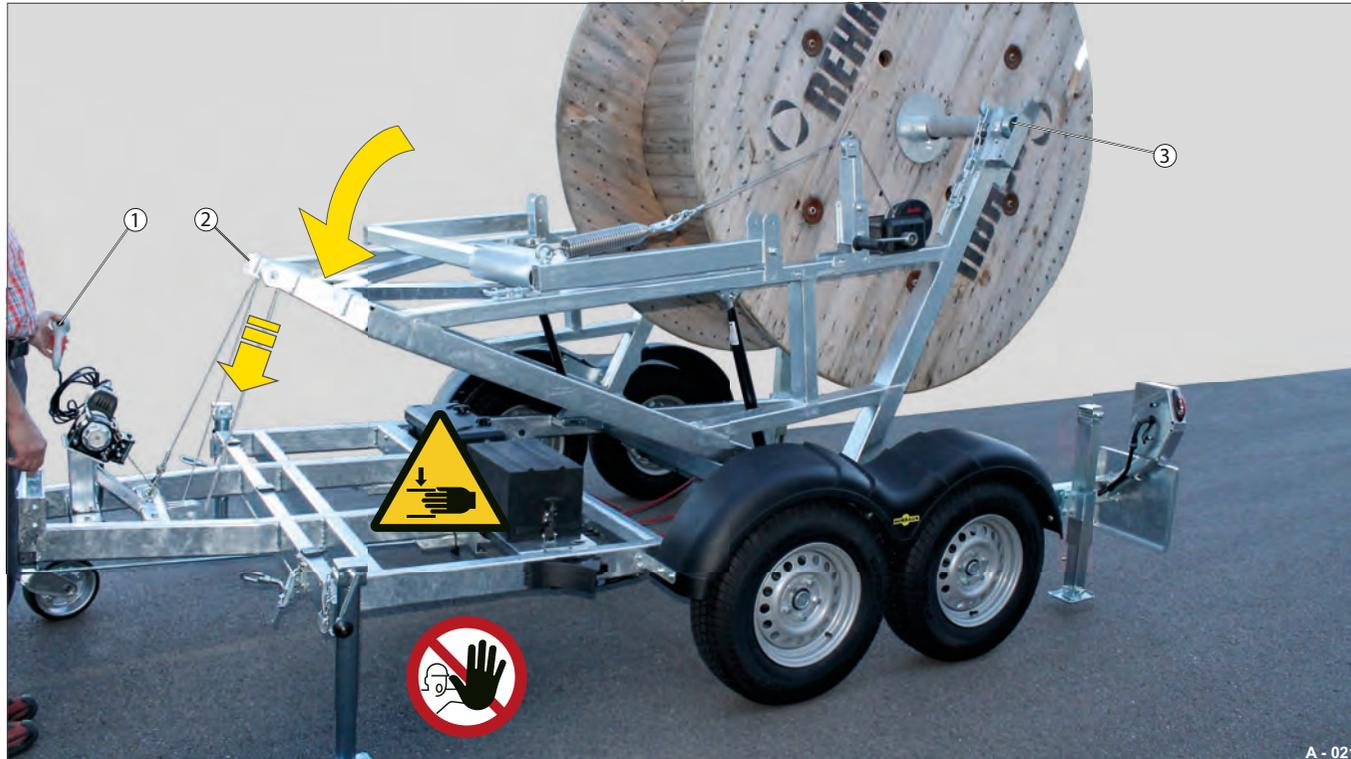
Fig. 12 Basculement du châssis porte-touret vers l'avant
