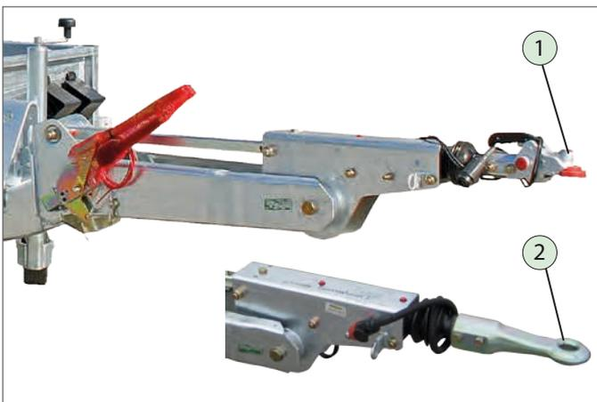
**SENKO - timon HV (dispositif d'attelage à boule de traction)**
