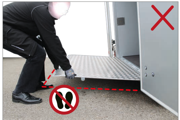
Crush area for ramp front edge
