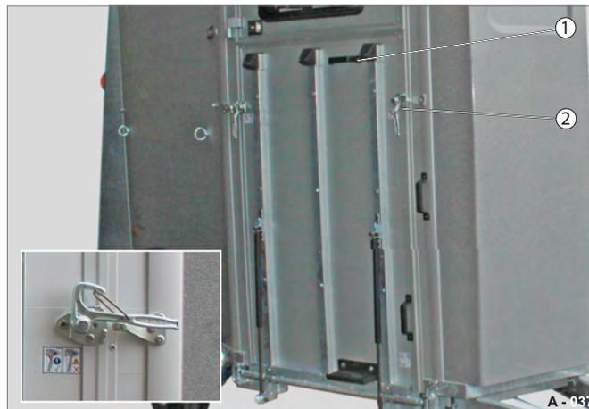
**Fig. 37** Ouverture de la descente avant
