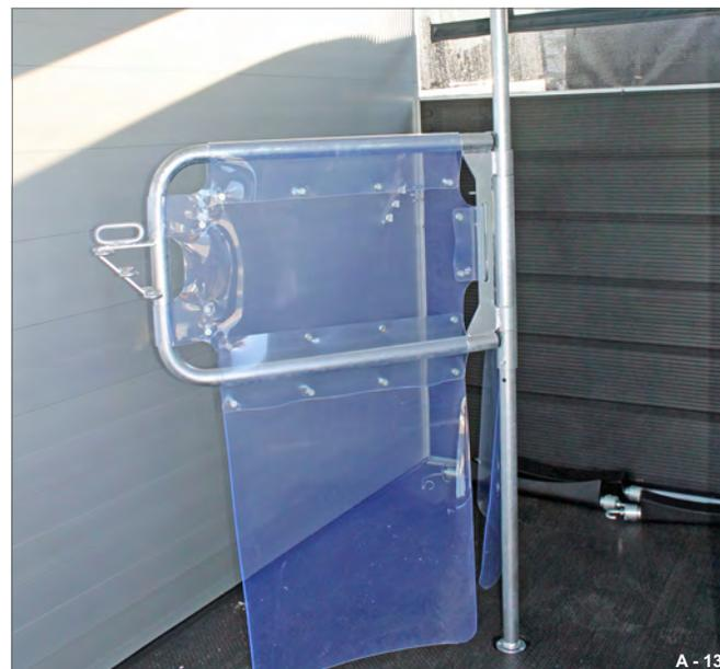
Fig. 132 position pivotée du bat-flanc (Notos)
