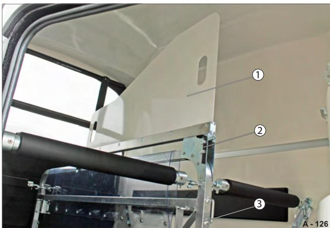
**Fig. 126** Séparation de tête montée / position d'arrêt
