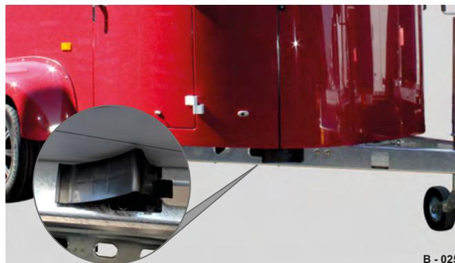
Fig. 25 Emplacement des cales sur modèle Maximus
