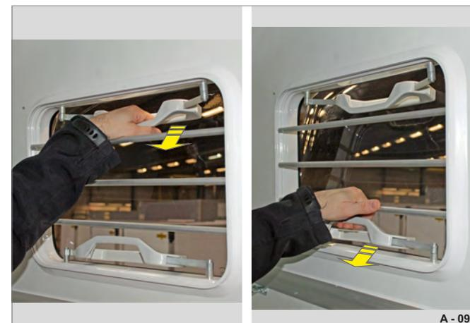
Fig. 94 Fermeture d'une fenêtre orientable de l'intérieur
