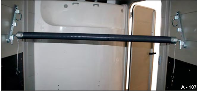
Fig. 107 Barres de poitrail et de recul (Single)
