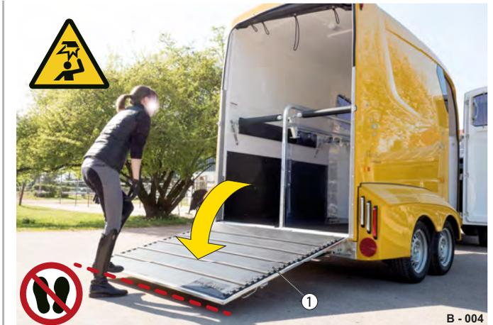
Fig. 4 Manipulation du hayon arrière
