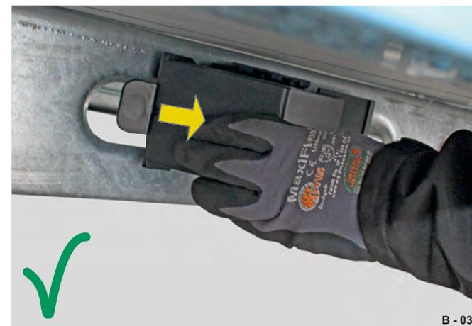
Fig. 30 Sécurisation des cales (en vue d'un trajet)
