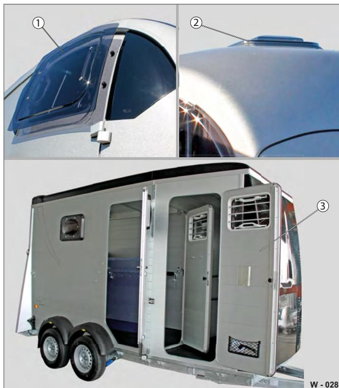
Fig. 28 Aération / séchage du van
