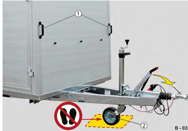
Fig. 32 Manœuvre manuelle de la remorque
