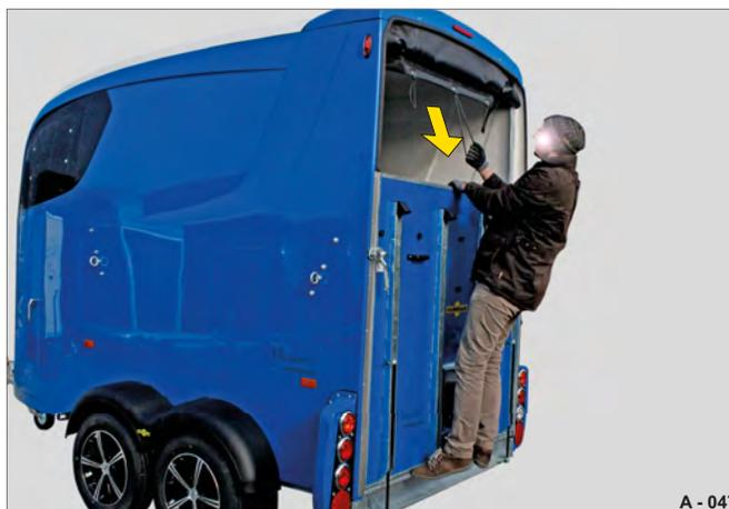
Fig. 47 Déploiement du Windschott / de la bâche
