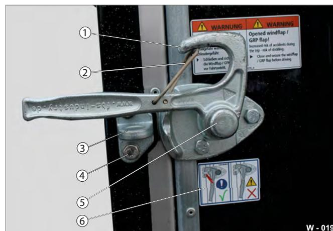
Fig. 19 Vérification des fermetures / du verrouillage
