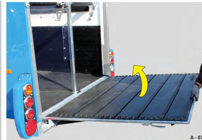
Fig. 75 Relèvement du hayon arrière
