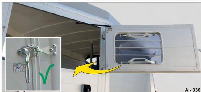
**Fig. 36** Fermeture du volet orientable
