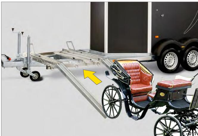
Fig. 11 Montée sur les rails de chargement
