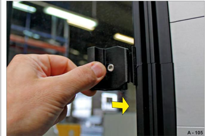
Fig. 105 Fermeture de la fenêtre coulissante
