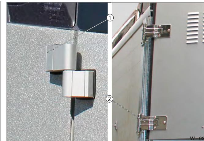
Fig. 20 Graissage des paumelles / charnières de portes
