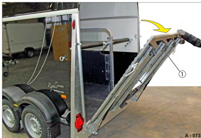
Fig. 73 Abaissement du hayon arrière
