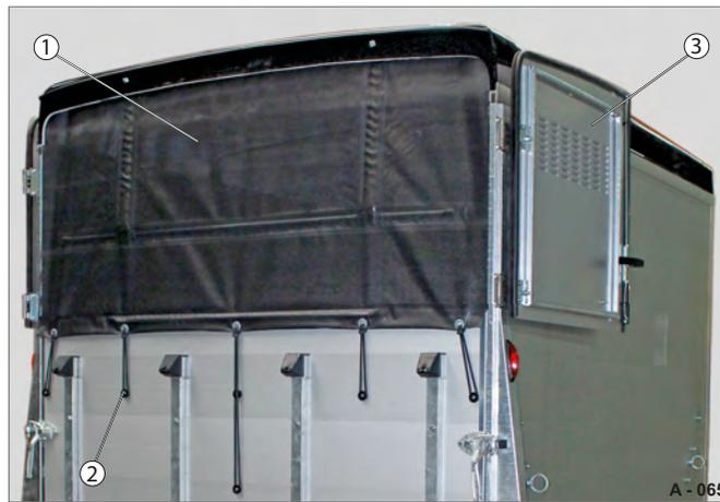
Fig. 65 Volets pivotants ouverts / position de conduite
