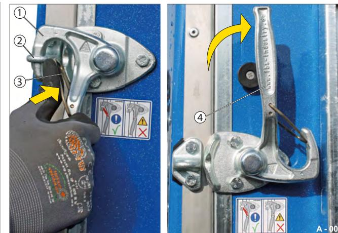
Fig. 4 Fermeture à levier coudé fermée / ouverte
