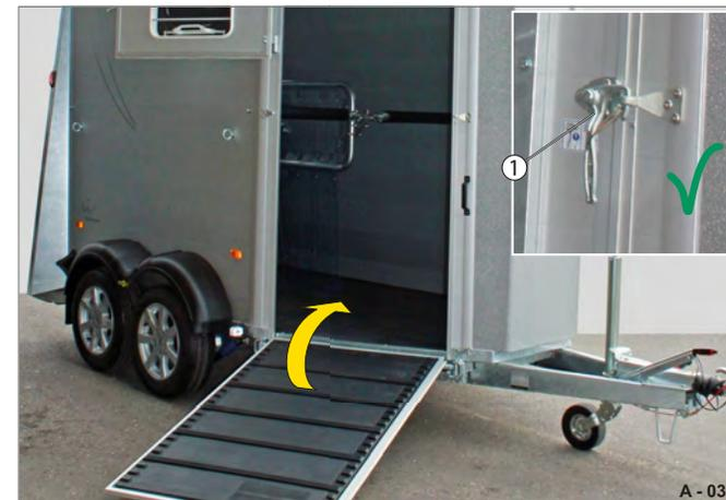
**Fig. 38** Fermeture de la descente avant
