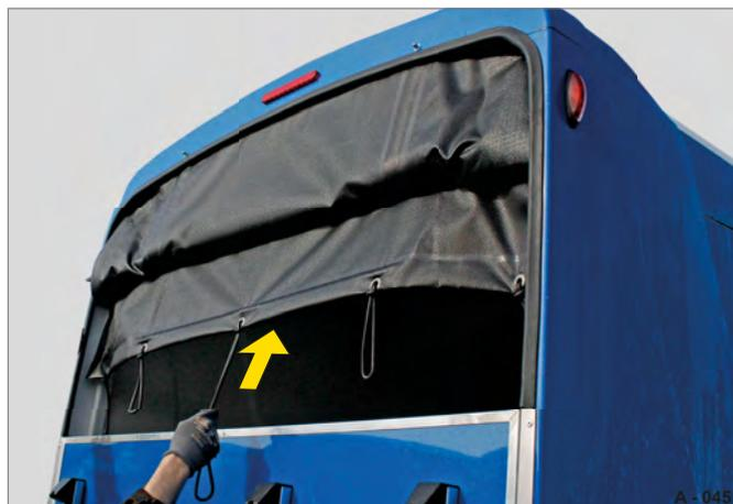
Fig. 45 Enroulement du Windschott / de la bâche
