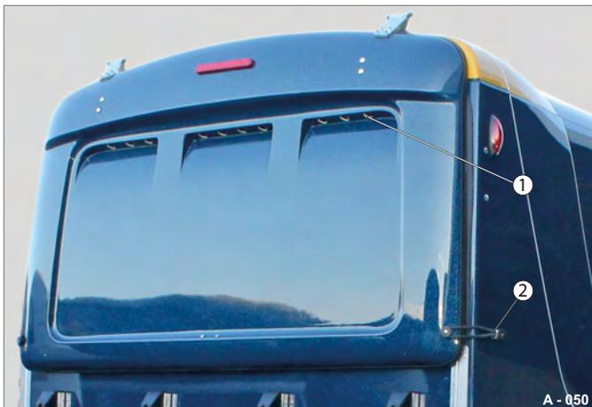
Fig. 50 Volet arrière en PRV fermé
