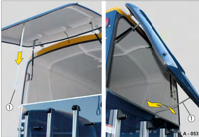
**Fig. 53** Abaissement du volet arrière en PRV / rangement de la sangle de manipulation
