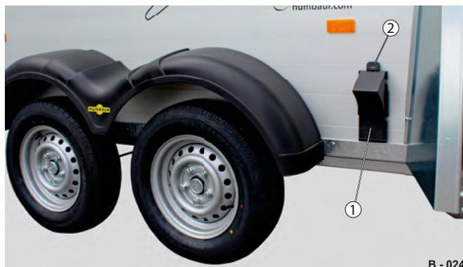
Fig. 24 Emplacement des cales sur modèle Zephir
