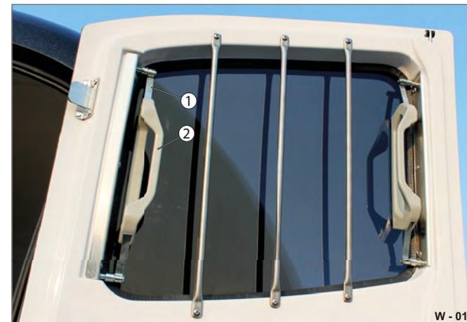
Fig. 16 Fenêtre orientable sur porte
