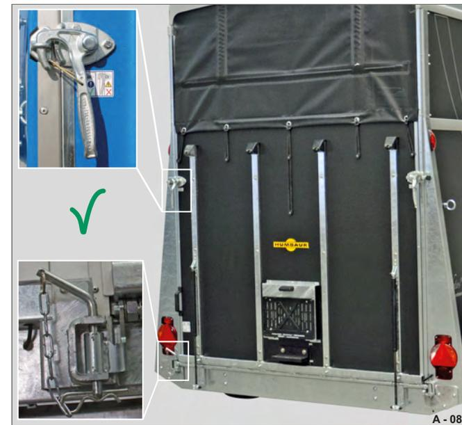
Fig. 85 Porte pivotante fermée et sécurisée
