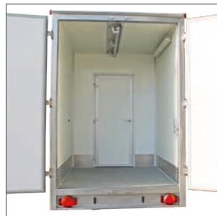
Structure compartimentée / Porte intérieure
