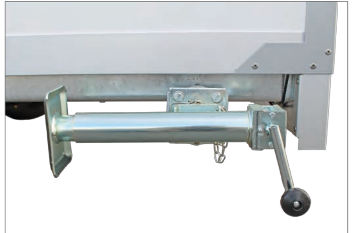
Béquilles télescopiques à manivelle en position de conduite
