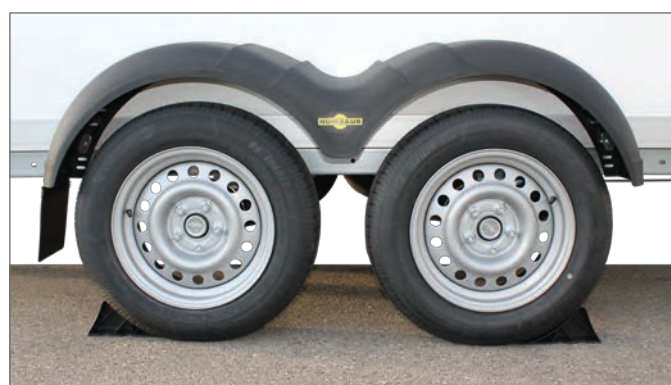
Mise en place des cales, essieu tandem
