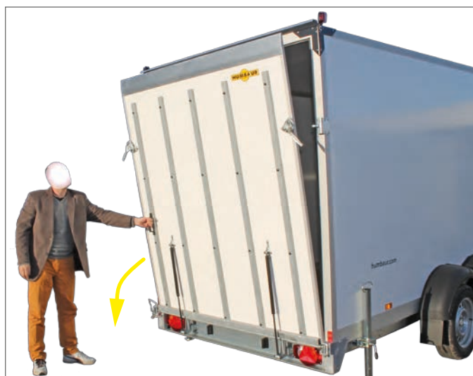
Abaissement du pont arrière
