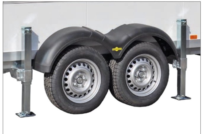
Béquilles télescopiques à manivelle en position d'appui
