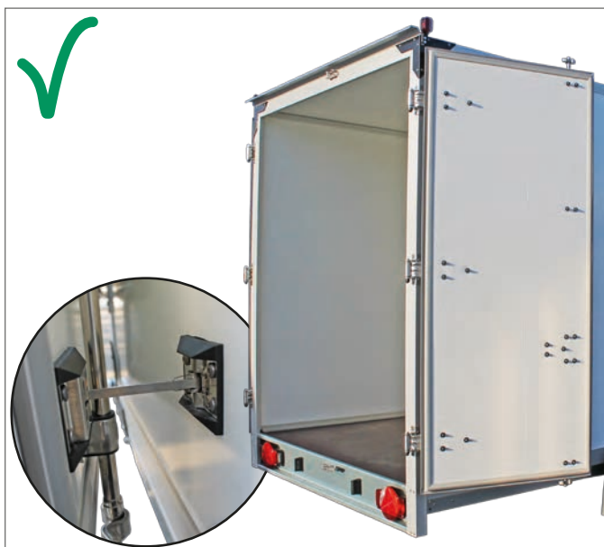
Porte à double battant ouverte, sécurisée
