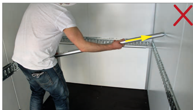
Endommagement de la paroi intérieure
