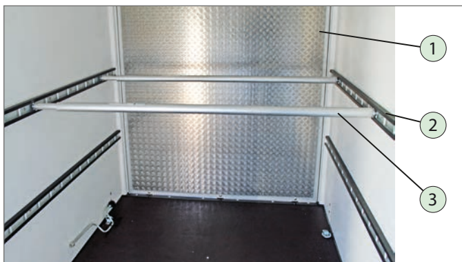
Rail d'arrimage à barreaux avec barre d'arrimage emboîtée
