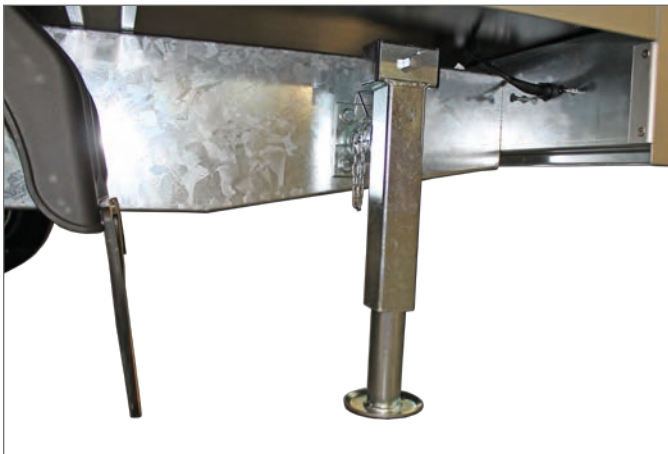
Béquilles télescopiques à manivelle en position d'appui
