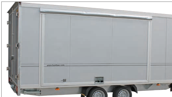
Volet de vente avec fermeture à bielle, position de conduite
