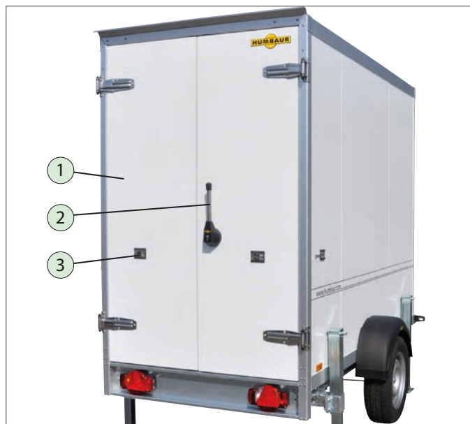
Porte de la cellule frigorifique avec déverrouillage de secours
