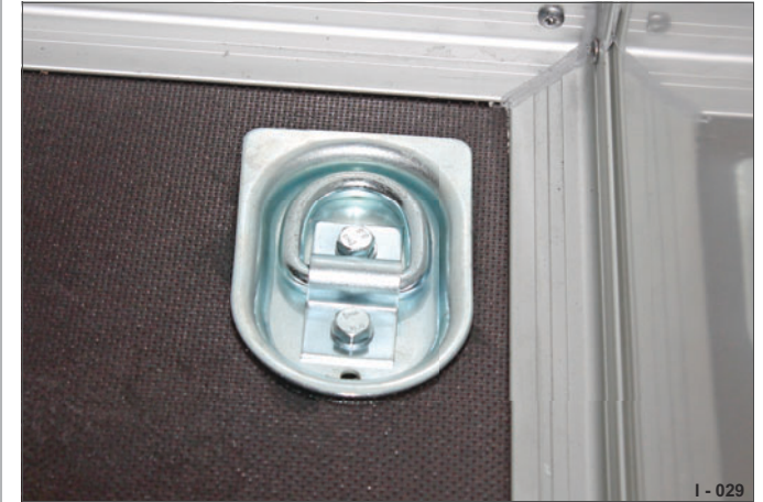
Fig. 14 encastrés au sol (pièce de renforcement)
