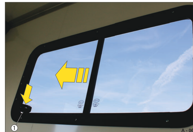
Fig. 20 Fenêtre coulissante fermée / verrouillée
