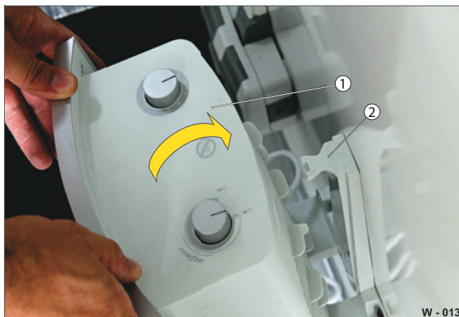
Fig. 8 Nettoyage / contrôle du radiateur à air pulsé
