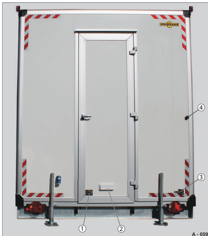
Fig. 1 Porte d'accès fermée (en position de conduite)
