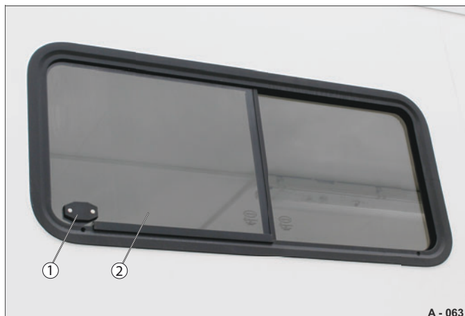
Fig. 17 Fenêtre coulissante fermée, vue de l'extérieur
