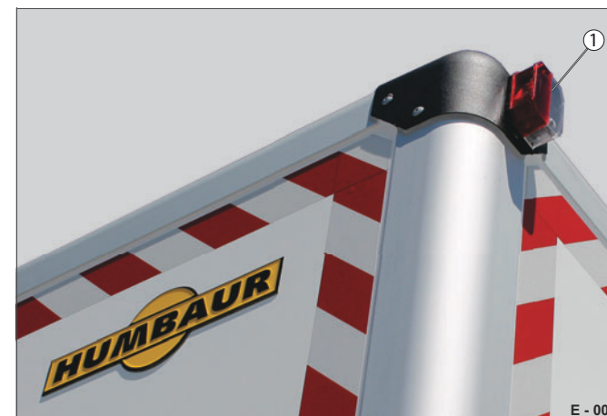
Fig. 4 Feu d'encombrement / de gabarit (en haut)
