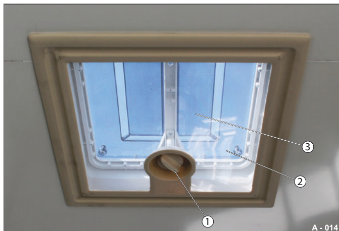
Fig. 14 Aérateur de toit
