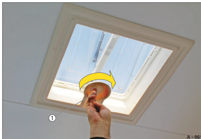
Fig. 15 Ouverture de l'aérateur de toit
