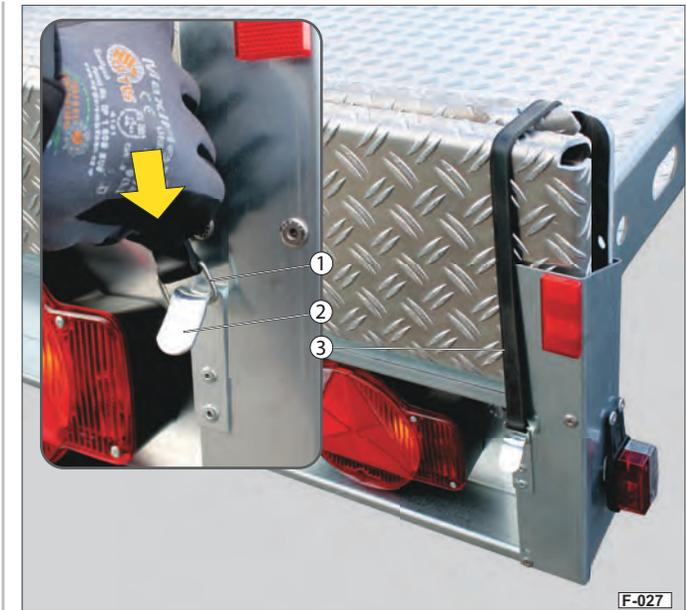
**Fig. 35** Rails de chargement sécurisé (en position de conduite)
