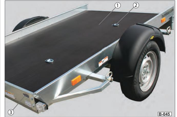
Fig. 21 Points d'arrimage de la surface de chargement (en option)
