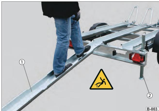
Fig. 1 Franchissement du rail de chargement
