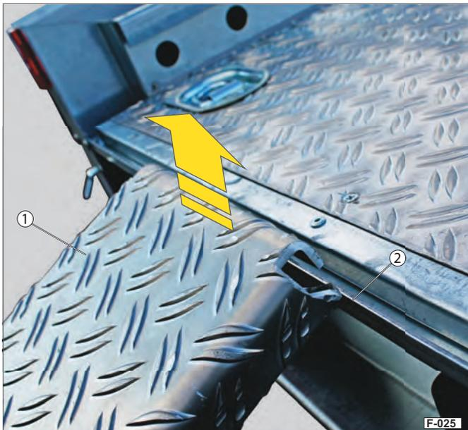
**Fig. 33** Rail de chargement décroché
