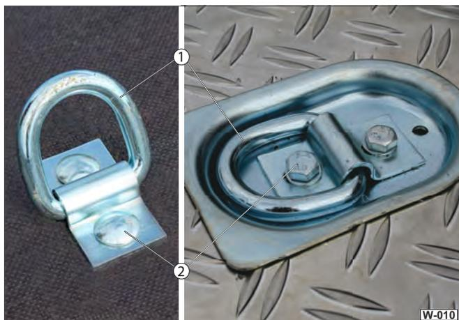
Fig. 10 Contrôle des points d'arrimage (en option)
