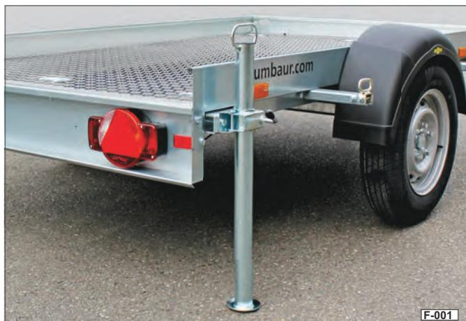
Fig. 1 Béquilles coulissantes en position d'appui
