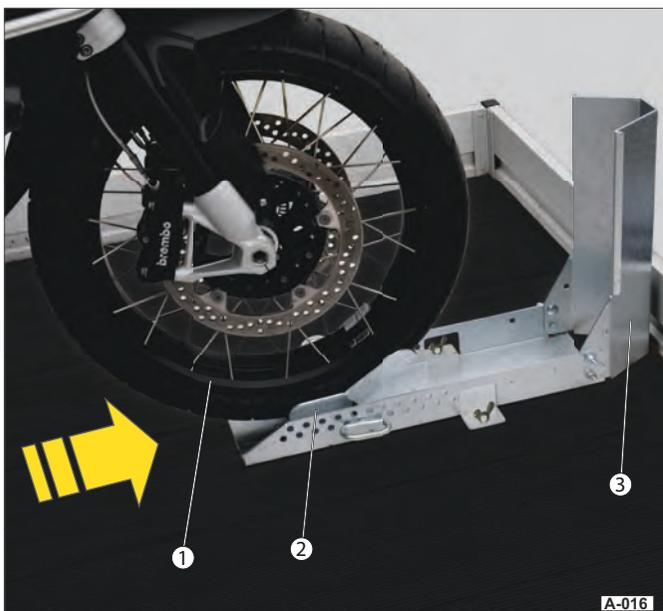
Fig. 16 Positionnement de la roue avant
