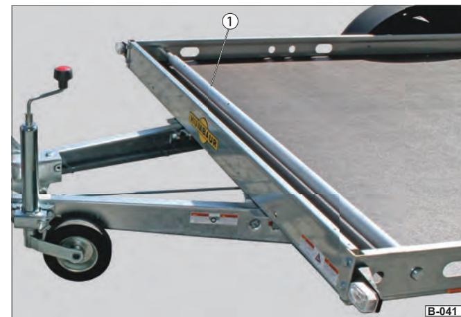
Fig. 47 Butoir de roues positionné
