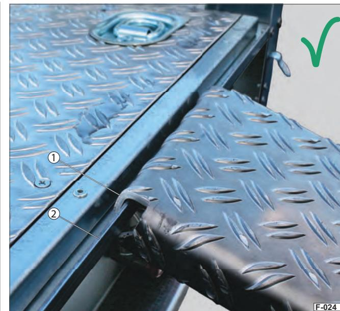
Fig. 32 Rail de chargement sécurisé
