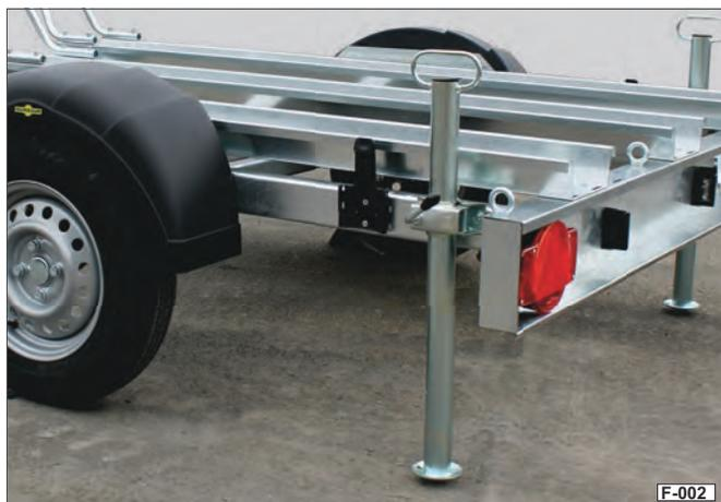
Fig. 3 Béquilles coulissantes en position d'appui
