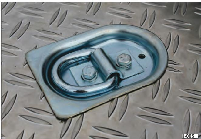
Fig. 6 Encastré dans le plancher (dépression)
