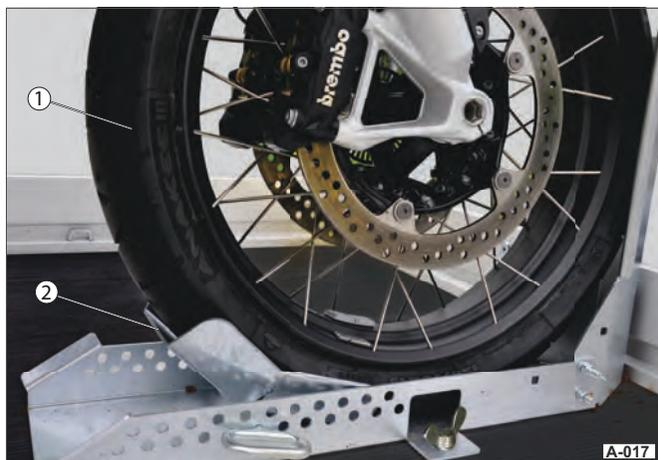
Fig. 17 Roue avant immobilisée
