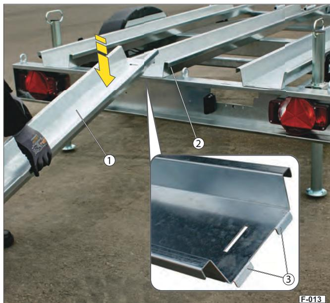
Fig. 13 Positionnement du rail de chargement
