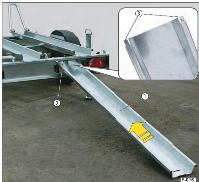
**Fig. 16** Positionnement du rail de chargement
