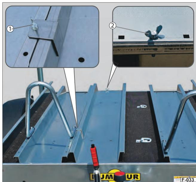
Fig. 26 Rail de chargement sécurisé (en position de conduite)
