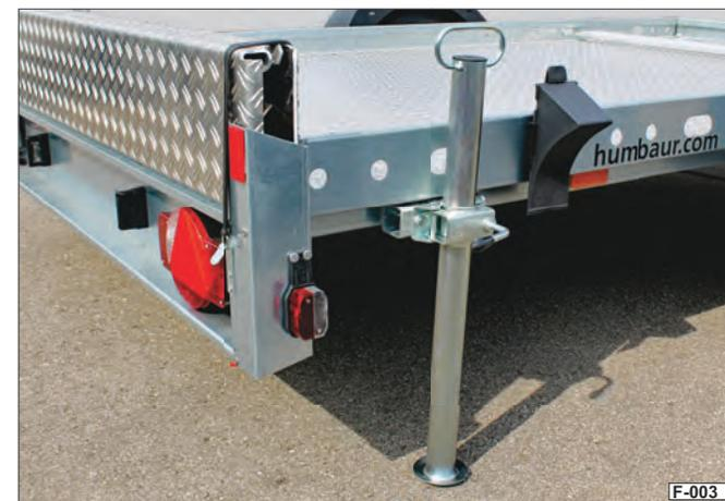
Fig. 5 Béquilles coulissantes en position d'appui
