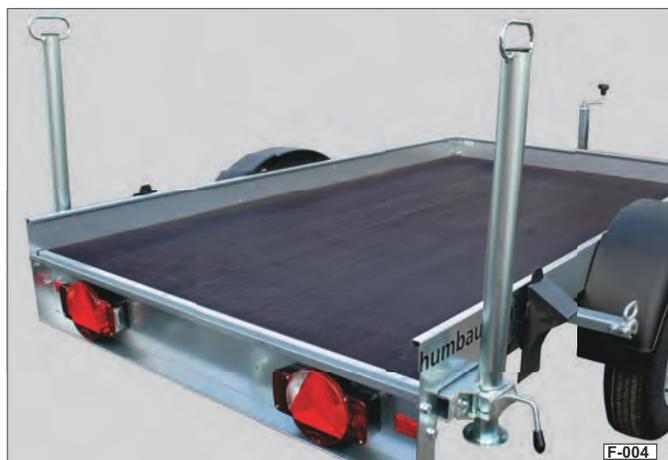
Fig. 2 Béquilles coulissantes en position de conduite
