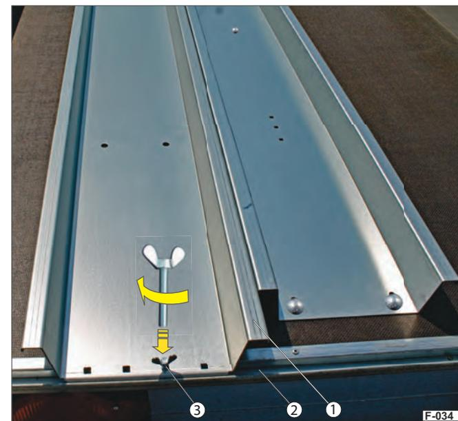
**Fig. 24** Rail de chargement positionné
