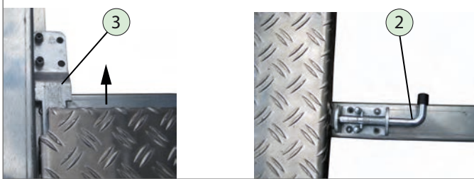
Introduire les rampes de chargement
