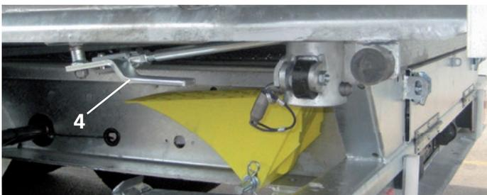
4. Levier de commande de la fonction d'oscillation (à l'arrière de la remorque, à gauche dans le sens de la marche)
