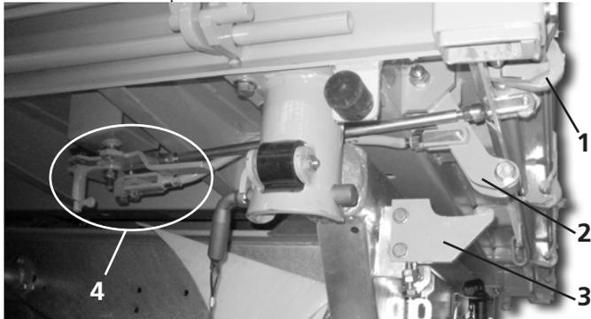
Dispositif de déverrouillage semi-automatique - aperçu
