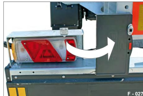
**Abb. 46** Warntafel zugeklappt
