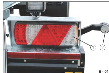
**Abb. 8** Heckbeleuchtung „LED“ 24 V
