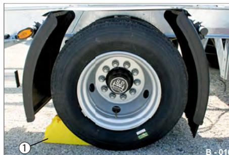
Abb. 11 Unterlegkeile angelegt
