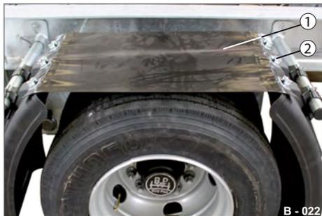
**Abb. 37** Radabdeckung / Plane befestigt
