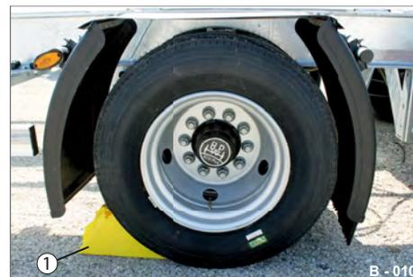
**Abb. 34** Unterlegkeile untergelegt
