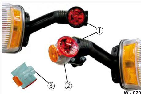
**Abb. 31** Gummiarm abziehen
