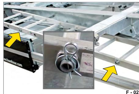
**Abb. 20** Aufstiegsleiter in Fahrstellung gesichert
