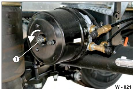
**Abb. 24** Feststellbremse lösen
