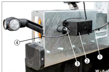
**Abb. 35** Heckbeleuchtung, Befestigung
