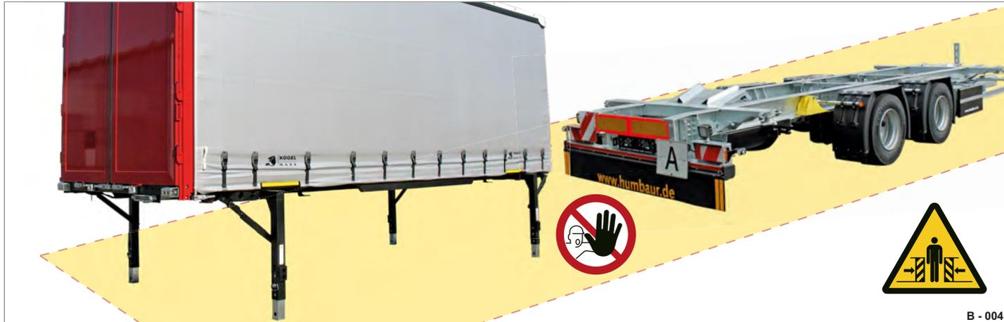
Abb. 16 Wechselbehälter umsetzen / aufnehmen
