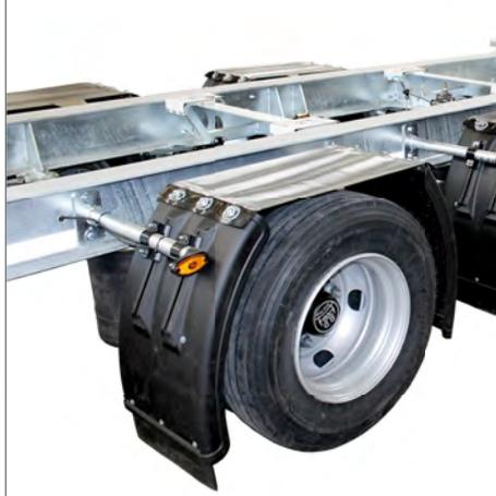
Abb. 17 Fahrgestell in Fahrstellung (RTR OptiLevel)
