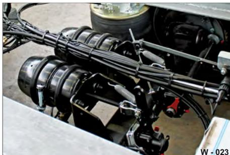
**Abb. 22** Membranzyylinder am hinteren Achsaggregat
