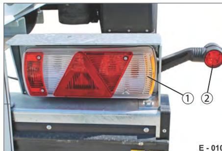
**Abb. 7** Heckbeleuchtung 24 V „Standard“
