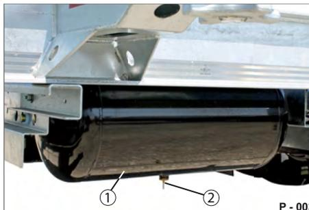
**Abb. 13** Druckluftbehälter unter Fahrgestell
