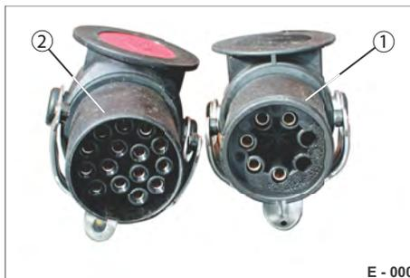
**Abb. 2** Steckverbindungen, Standard 24 V
