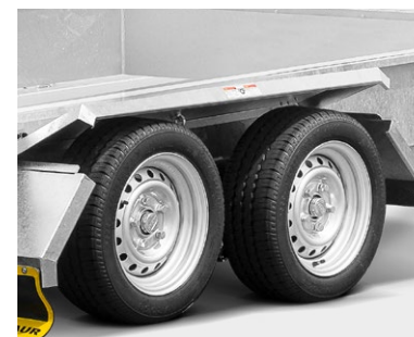
Stalen spatborden, automatisch openend en sluiten tijdens het dalen
