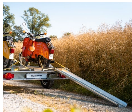
1 oprijrail geïntegreerd in de plankenschacht
