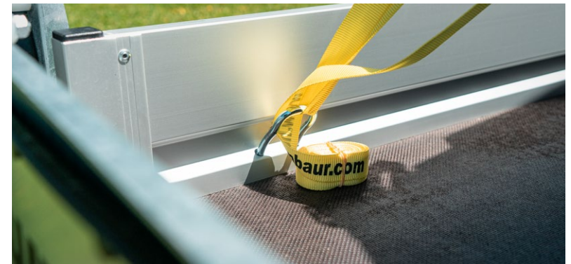
▲ Sjorringen met Humbaur-sjorband ▼ Detailaanzicht achterzijde
