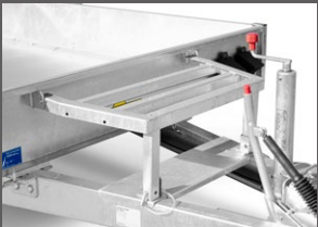
Opvouwbare graafmachinesteun voor V-trekhaak
