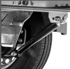
Wielschokdemper gemonteerd incl. 100 km/h bevestiging
