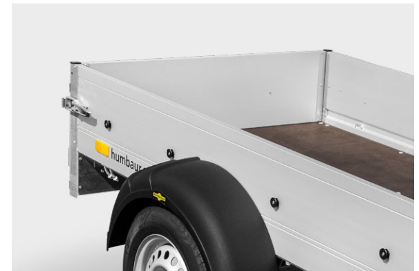
Perronhekken van geanodiseerd, dubbelwandig aluminium profiel
