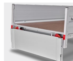
rechts Sjorringen geïntegreerd in de zijwanden
