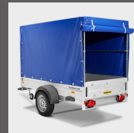
Dekzeil & bogen, laadhoogte 1000 / 1300 / 1600 / 1800 mm (ontwerp afhankelijk van model)
