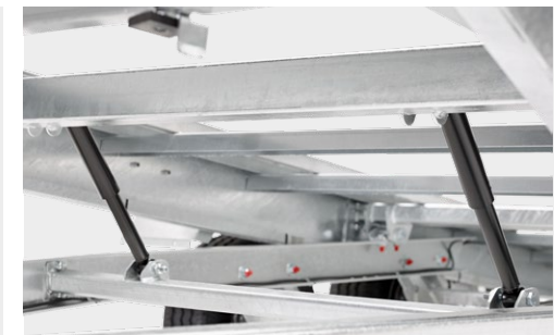
Amortisseur pour la fonction de basculement mécanique
