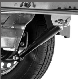
Amortisseur de roues avec homologation pour une vitesse de 100 km/h
