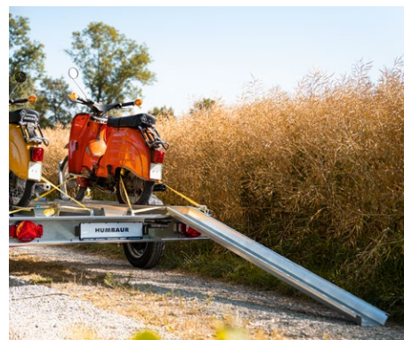
1 rampe d'accès intégrée dans la cage de madrier
