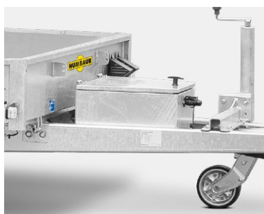
Boîtier de timon pour protéger la batterie et le système hydraulique de descente
