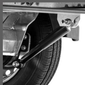
Amortisseurs de roues (montés) avec homologation pour une vitesse de 100 km/h
