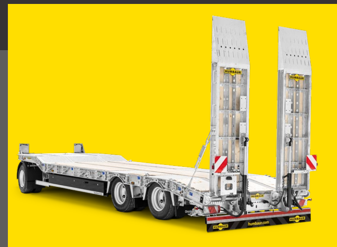
Rubber vloerbedekking op aluminium panelen voor hellingen
