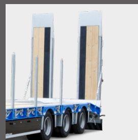
Rubber vloerbedekking op aluminium panelen voor hellingen
