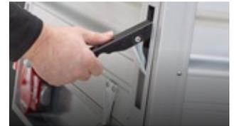
Klappbare Bordwände mit versenkbaren Verschlüssen.
