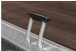
4 Stück Zurrbügel im Außenrahmenprofil
