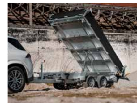
La HTK peut basculer en arrière et sur le côté en un tournemain.
