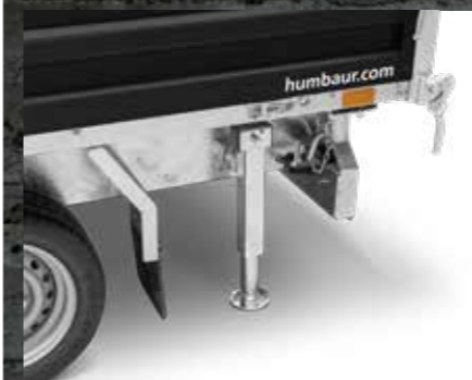
SUPPORTS TÉLESCOPIQUES À MANIVELLE Stabilité optimale, rabattable
