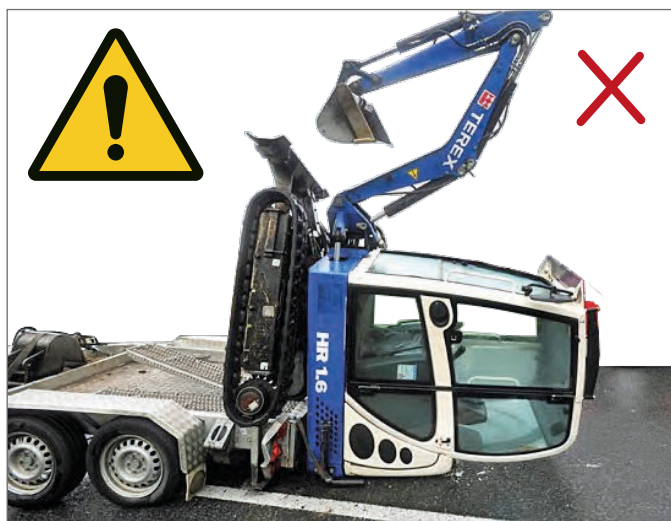
Ongeval voorbeeld (minigraafmachine was niet vastgesjord)
