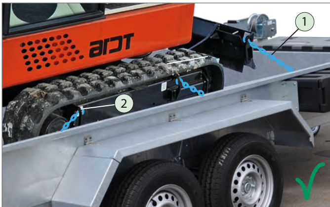
Voorbeeld 'krachtgesloten ladingbeveiliging' / mini-graafmachine
