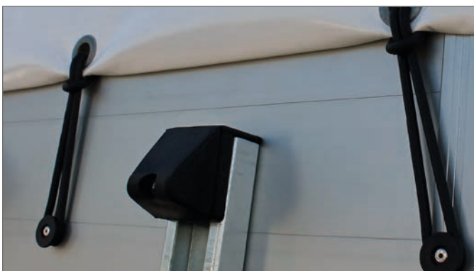
Dekzeilgedeelte aan de achterzijde, elastieke randsluiting gespannen
