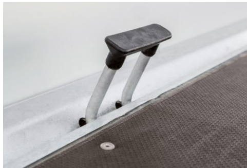
Sjorbeugels zijn standaard in het buitenframe geïntegreerd
