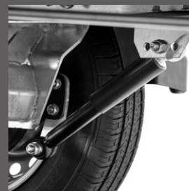
Wielschokdempers (gemonteerd) incl. 100 km/h-goedkeuring
