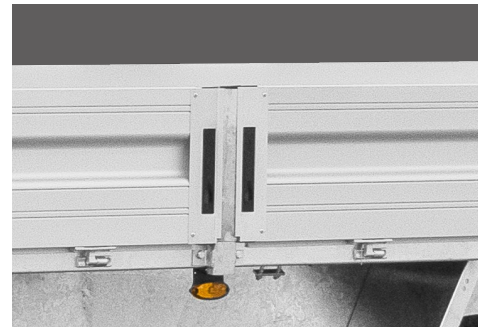
In het midden gemonteerde ronnen op de zijwanden (binnenlengte vanaf 6100 mm)
