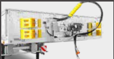
Aansluitingen voor lucht- en elektratoevoeringen naar trekker aan de voorwand
