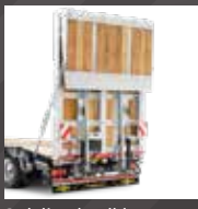
2-delige laadklep over de gehele breedte met houten afdekking
