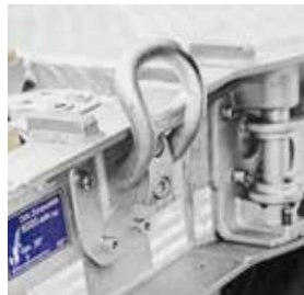
De sjorogen aan de zijkant blijven in elke gewenste positie staan en zijn ook eenvoudig bereikbaar vanaf de laadvloer.
