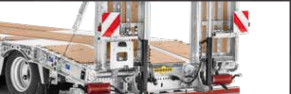
Oprijplaat uit een deel met hydraulische oprijplaatlift
