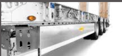
Opbergkist voor houten planken (verbredingspakket van 3 meter)
