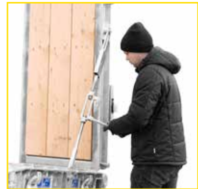
Met de gebruiksvriendelijke spanschroeven is de oprijplaat snel vast te zetten.
