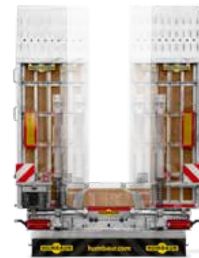
Verschiede oprijbreedtes zijn direct mechanisch of optioneel hydraulisch in te stellen
