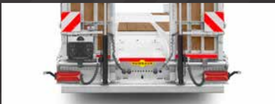
Oprijplaat uit een deel met hydraulische oprijplaatlift
