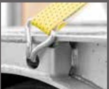
In het buitenframe geïntegreerd sjorpunt met max. 3 ton sjorkracht
