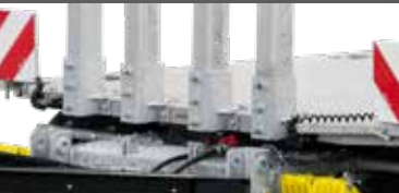
Steunpoten en insteekringen aan de voorzijde, waarschuwingspaneel
