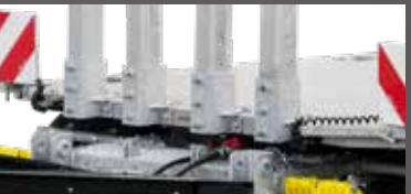
Steunpoten en insteekronden aan de voorzijde, waarschuwingspaneel
