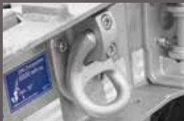
In het buitenframe geïntegreerd siorpunt met max. 6 ton siorkracht
