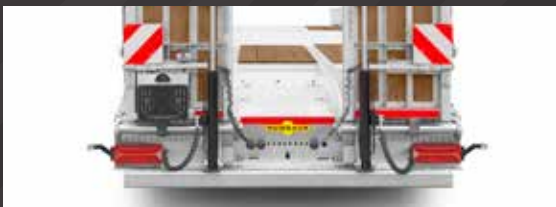
Oprijplaat uit een deel met hydraulische oprijplaatlift
