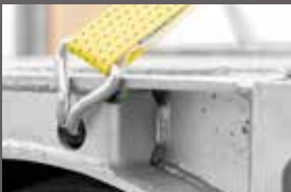
In het buitenframe geïntegreerd siorpunt met max. 3 ton siorkracht
