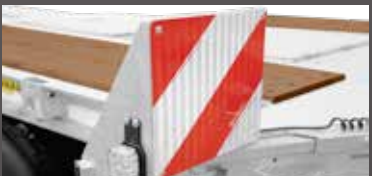
Uittrekbaar waarschuwingspaneel met verlichting
