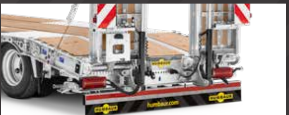
Oprijplaat uit een deel met hydraulische oprijplaatlift
