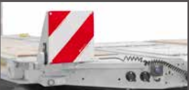
Uittrekbaar waarschuwingspaneel met verlichting
