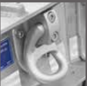
In het buitenframe geïntegreerd sjorpunt met max. 6 ton sjorkracht
