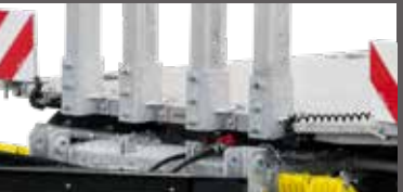
Steunpoten en insteekringen aan de voorzijde, waarschuwingspaneel
