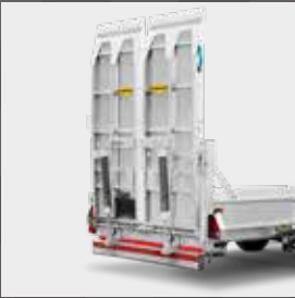
Eendelige brede oprijplaat met stalen tralierooster
