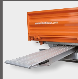
2 aluminium oprijplaten, onder de laadruimte intrekbare
