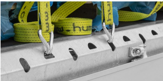
Lochaußenrahmen – besonders flexible Ladungssicherung
