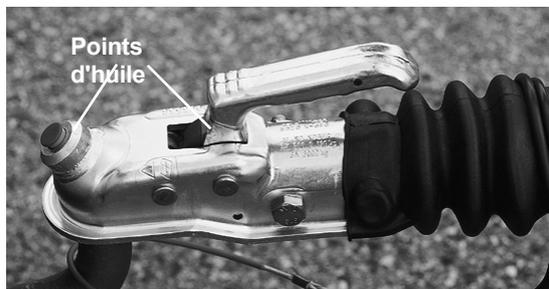
Aux endroits indiqués sur l'illustration *des points d'huile de l'attelage à boule*, vous devez huiler l'attelage avec une huile pour machine usuelle. Quelques gouttes d'huile suffisent. Essayez le surplus d'huile avec un chiffon pour éviter qu'il ne se répande dans l'environnement.
