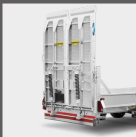
Rampes larges d'une seule pièce avec caillebotis en acier
