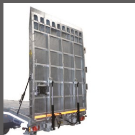
Paroi de franchissement hydraulique avec caillebotis en acier
