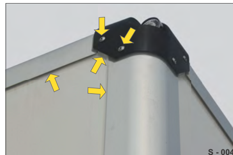
Abb. 6 Eckverbindung / Einfassprofile oben ► Prüfen Sie die Nieten auf Festsitz. ► Prüfen Sie die Verklebung auf Risse.
