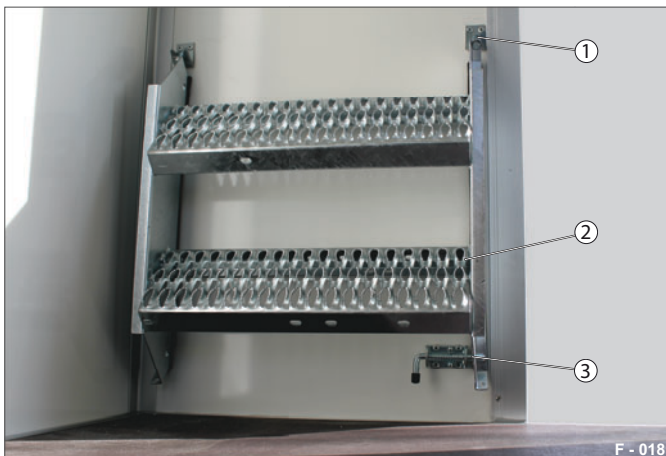
Abb. 8 Treppe innen gesichert (Fahrstellung)
