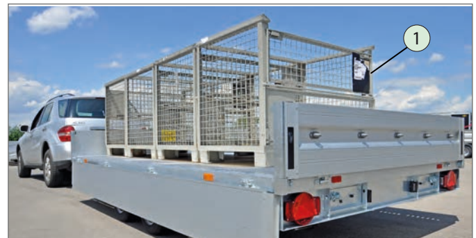
Beispiel „Formschlüssige Ladungssicherung“
