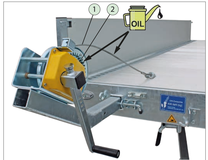
Seilwinde prüfen / ölen
